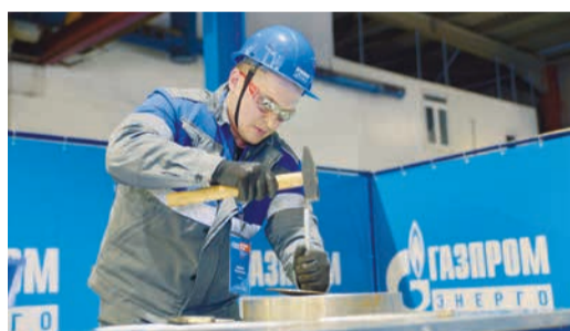
Вырубка стальной листовой прокладки
