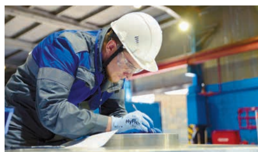
Разметка стальной листовой прокладки
